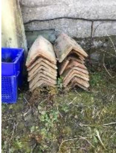
*Les faîtières ordinaires* : Ce type de faitières simple sans emboîtement est fabriqué par les deux manufactures, estampillé à leur nom et est maintenu sur la crête du toit par du mortier, ce qui les rend, à plus ou moins long terme, plus susceptibles aux infiltrations d'eau de pluie. Dimensions 46 cm avec à l'équerre de lèvres de 17 cm.
